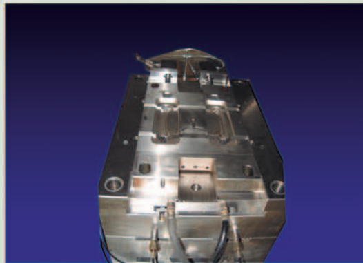
Spritzgießwerkzeug Türgriff mit Gasinnendrucktechnik Formgröße: 595 x 442 x 467
