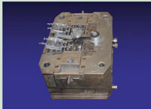
Druckgießwerkzeug Gehäuse für HF -Verstärker Formgröße: 596 x 396 x 420 inkl. Beschnittwerkzeug
