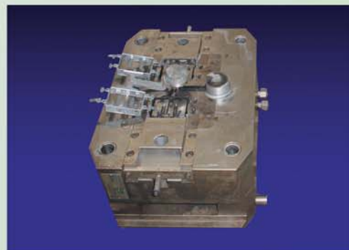
Druckgießwerkzeug Gehäuse für HF -Verstärker Formgröße: 596 x 396 x 420 inkl. Beschnittwerkzeug
