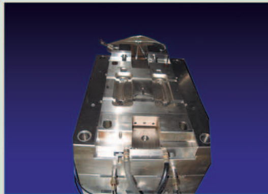
Spritzgießwerkzeug Türgriff mit Gasinnendrucktechnik Formgröße: 595 x 442 x 467
